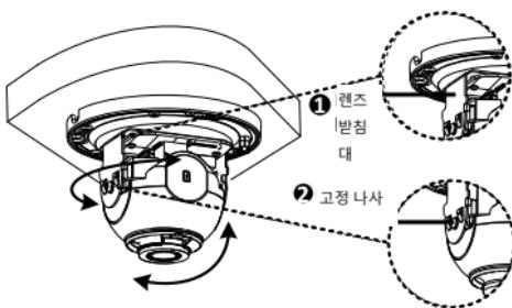
6. 라이닝을 붙이고 받침대의 버를 속으로 고정합니다. 다음은 2 축 및 3 축 카메라의 설치 방법을 보여주고 있습니다. 라이닝은 다릅니다. 차이는 실제 제품을 참조하십시오.
